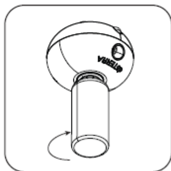
3. Переверните диффузор вверх дном, вставьте в крепление флакон с эфирным маслом объемом 5 или 15 мл и плотно закрутите по часовой стрелке. Примечание: Перед установкой флакона не снимайте с него капельный дозатор.
