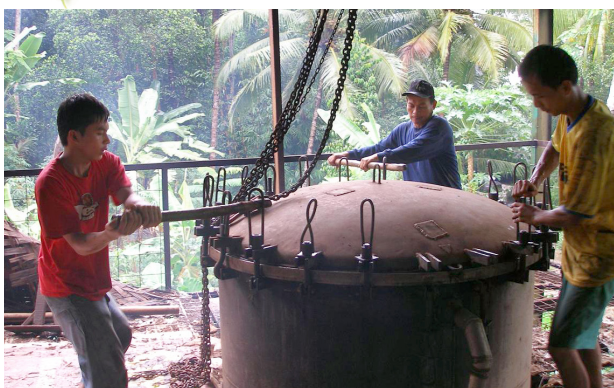
Minyak esensial Ylang Ylang diekstrak dengan kaedah penyulingan wap di Madagascar
