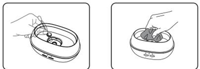
Limpe o Reservatório de Água e Placa de Névoa pelo menos duas vezes por semana. Limpe a Placa de Névoa no Reservatório de Água com um tecido de algodão e limpador neutro. Lave com água limpa e seque com um pano macio.
