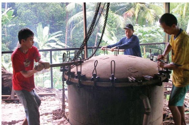
在马达加斯加以蒸馏法提炼的依兰依兰精油
